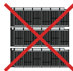
Schéma 3.: Nevhodné ukladanie panelov v radoch pod sebou.
